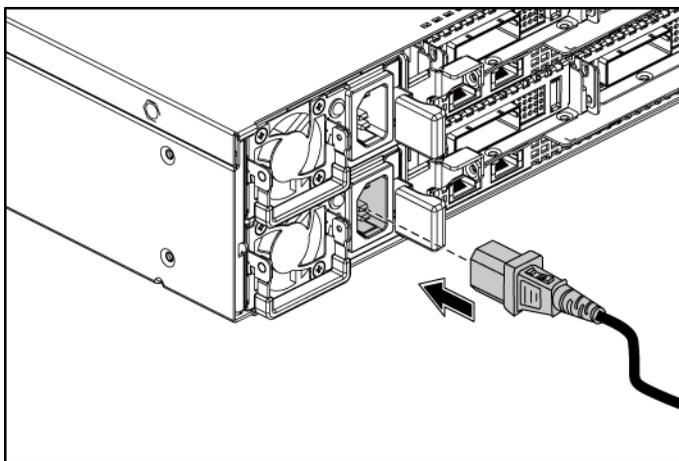
Připojte napájecí kabely k systému, a pokud používáte monitor, připojte napájecí kabel také k monitoru. Poté zasuňte druhý konec napájecích kabelů do uzemněné elektrické zásuvky nebo je připojte k samostatnému zdroji napájení, například ke zdroji nepřerušitelného napájení (UPS) nebo jednotce rozvaděče (PDU).
