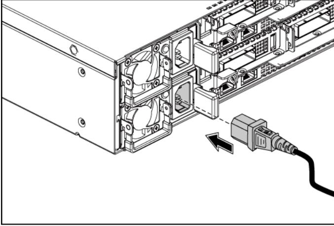
Sistemin güç kablosunun/kablolarının sisteme bağlantısını yapın ve bir monitör kullanılıyorsa, monitör güç kablosunun monitöre bağlantısını gerçekleştirin. Güç kablolarının diğer ucunu topraklı bir elektrik prizine ya da kesintisiz güç kaynağı veya güç dağıtım birimi gibi ayrı bir güç kaynağına takın.
