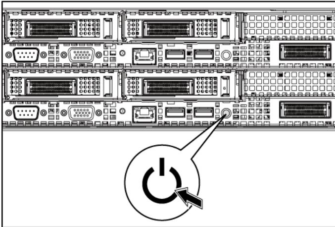
Presione el botón de encendido de la parte frontal o posterior del sistema y el monitor. Los indicadores luminosos de alimentación deberían encenderse.
