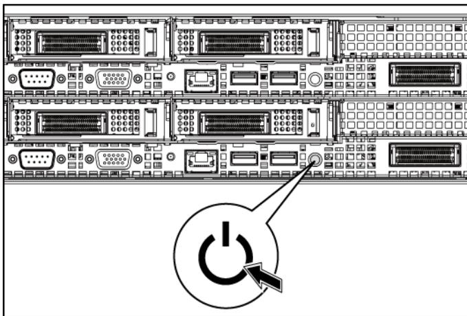
Нажмите кнопку питания на передней или задней панели системы и на мониторе. Загорятся индикаторы питания.
