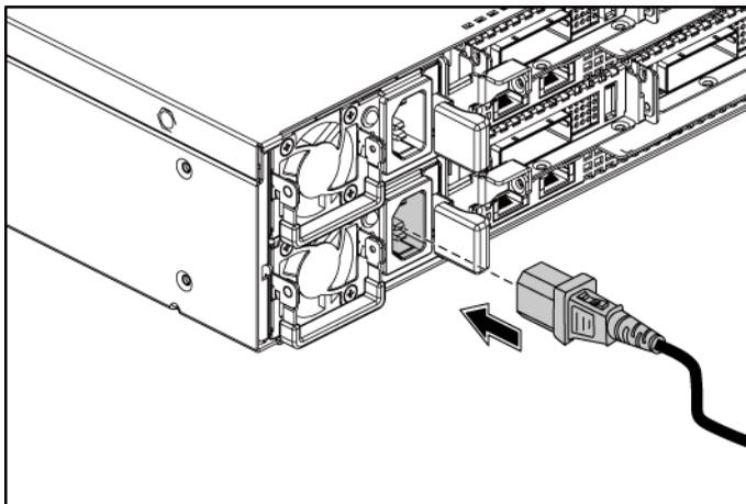
Schließen Sie das/die System-Netzstromkabel am System an. Falls ein Bildschirm verwendet wird, schließen Sie auch hier das zugehörige Netzstromkabel an. Verbinden Sie das andere Ende des Netzstromkabels mit einer geerdeten Steckdose oder einer separaten Spannungsquelle, etwa einer unterbrechungsfreien Stromversorgung oder einem Stromverteiler.
