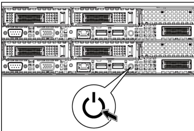
Stiskněte vypínač na předním nebo na zadním panelu systému a na monitoru. Indikátory napájení by se měly rozsvítit.
