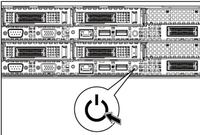
Πατήστε τα κουμπιά λειτουργίας είτε στο εμπρός είτε στο πίσω μέρος του συστήματος και στην οθόνη. Ανάβουν οι λυχνίες λειτουργίας.
