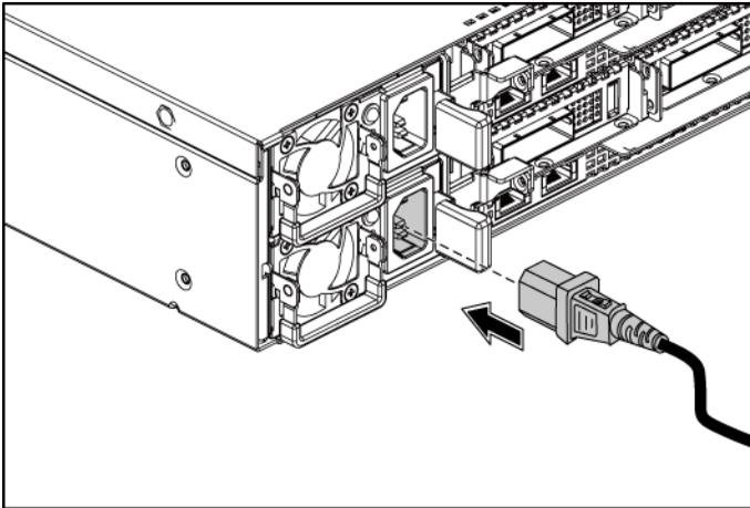
Συνδέστε τα καλώδια τροφοδοσίας του συστήματος στο σύστημα και, εάν χρησιμοποιείτε οθόνη, συνδέστε το καλώδιο τροφοδοσίας της οθόνης στην οθόνη. Βυσματώστε το άλλο άκρο των τροφοδοτικών καλωδίων σε μια γειωμένη ηλεκτρική πρίζα ή μια ξεχωριστή πηγή ρεύματος, όπως μια συσκευή αδιάλειπτης παροχής ρεύματος ή μια μονάδα διανομής ρεύματος.
